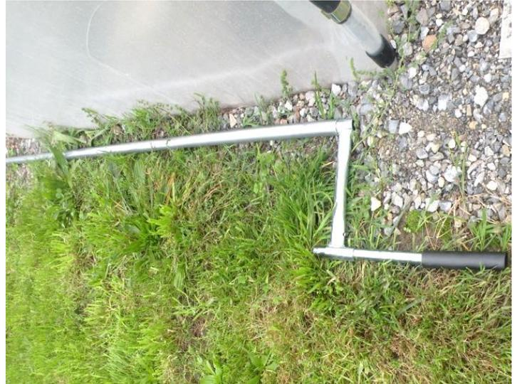
La manivelle (article 9) est fournie avec un raccord à vis prémonté (article 9.1 - 9.2) pour le tube de rouleau. Veuillez desserrer et utiliser cette connexion pour l'assemblage.
